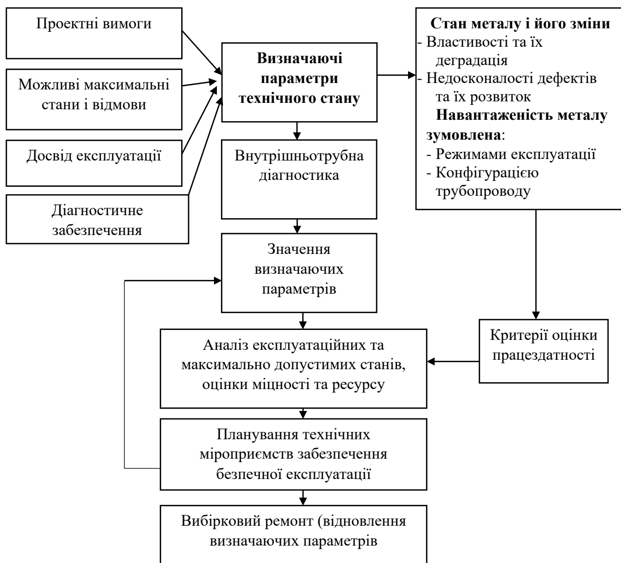
Рис. 3.7. Схема реалізації концепції безпечної експлуатації магістральних трубопроводів ТОВ «НАДРАГАЗВИДОБУВАННЯ»*
