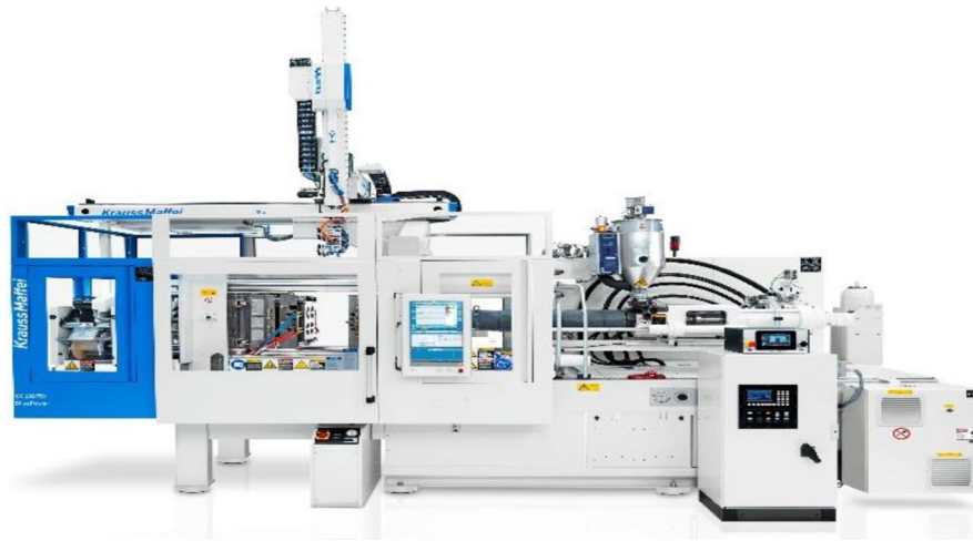
Рис. 2.2. Інженерно – ливарна машина термопластавтомат KraussMaffei, яка виробляє біополімерну продукцію.
